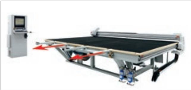
I bracci della ribaltina si mettono automaticamente in posizione di carico.
