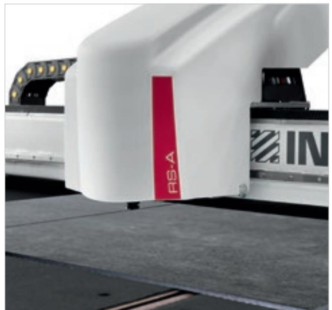
La testa operatrice è provvista di un sistema automatico di gestione della pressione di taglio che permette di dosare in maniera corretta la forza esercitata dalla rotella dall'inizio alla fine del taglio. La gestione della velocità degli assi e la componentistica elettronica e meccanica di alta qualità permettono di ottimizzare i tempi di lavorazione, garantendo flessibilità e dinamicità.
