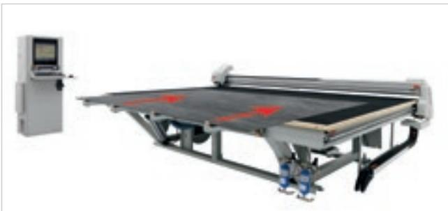
I piedini a scomparsa si riposizionano automaticamente in posizione di sicurezza per inizio taglio. La testa operatrice comincia automaticamente il ciclo di taglio.
